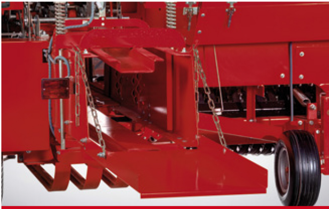
Ruota per lavorare anche nei campi con i solchi. / Rear wheel to help working on fields with furrows. / Rueda trasera para estabilizar el trabajo en los surcos de serie en todos los modelos. / Roue postérieure appropriée sur champs sillonnés.
